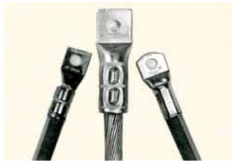
Estes conectores de compressão não exigem uma formação longa para os montadores, por conseguinte, são mais independentes da qualidade de mão-de-obra. No entanto, é absolutamente necessário usar a correta matriz com ferramentas corretas e calibradas. As duas condições são potenciais fontes de erros que levam a falha.
