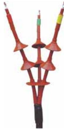
Essa técnica foi melhorada por co-extrusão de uma camada isolante elastomérica que permitiu desenhar emendas e acessórios desconectáveis. A camada retrátil externa mantém expandida a camada abaixo antes de encolher.
